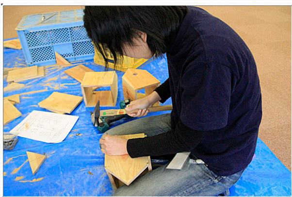
板材に釘を打つ。割れない様にあらかじめドリルで小さく穴を空けておいた。
